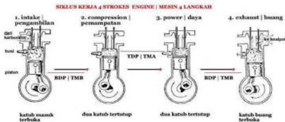
Gambar 1.1 Siklus kerja motor bensin 4-langkah
