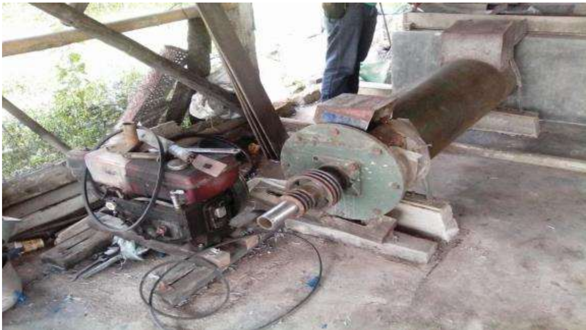
Gambar 4.1. Kondisi Mesin Pengering Plastik yang selama ini Digunakan KPS Lampung untuk Meringkakan Sampah Plastik
