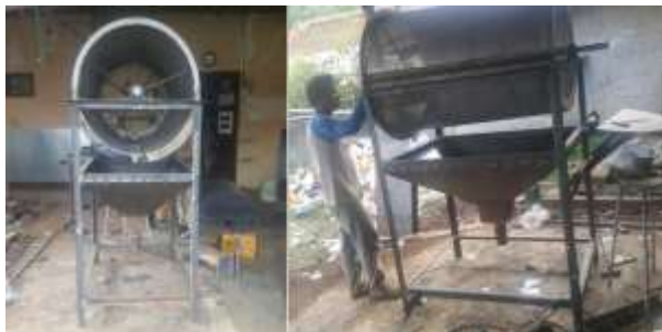
Gambar 4.5. Mesin Pengering Plastik sebagai Produk Teknologi yang Didesiminasikan ke Masyarakat.
