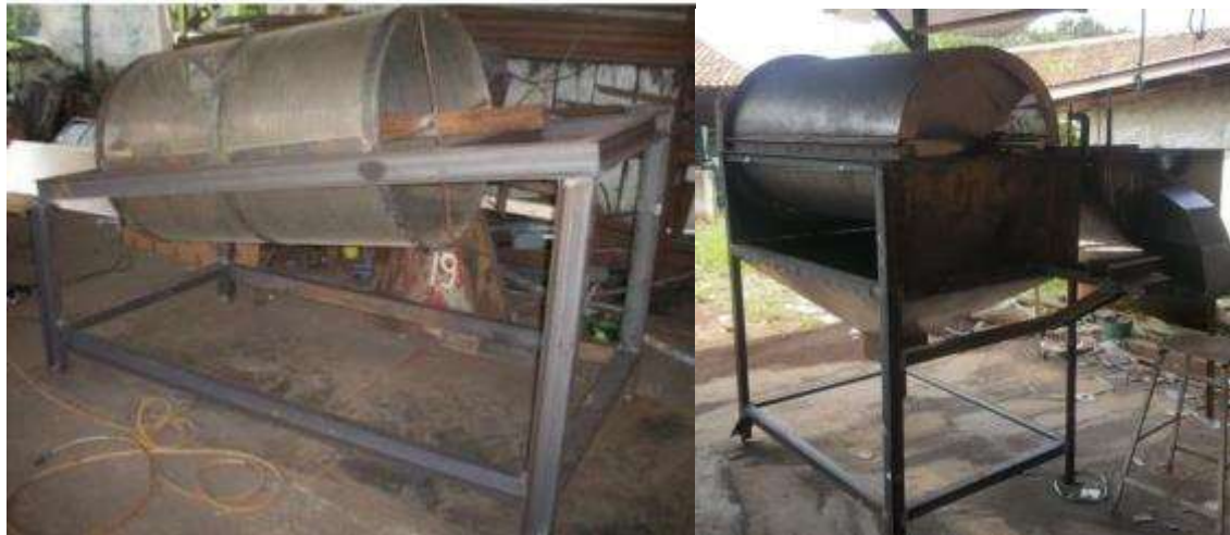
a. Posisi tabung sebelum modifikasi b. Posisi tabung setelah modifikasi Gambar 3.1. Posisi Tabung Pengering Plastik Sebelum dan Setelah Modifikasi
