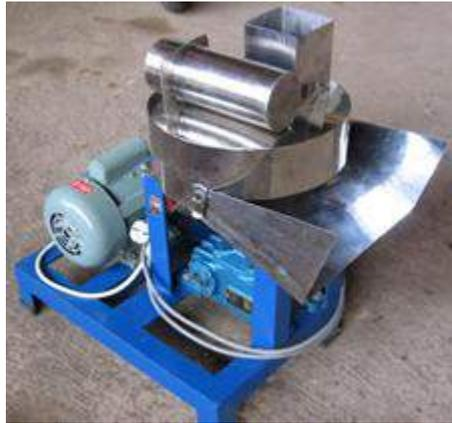
**Gambar 2. Mesin Pengiris Keripik Singkong / Pisang.**
