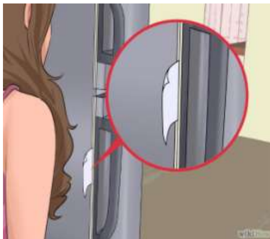
Gambar Memeriksa kerapatan pintu kulkas
