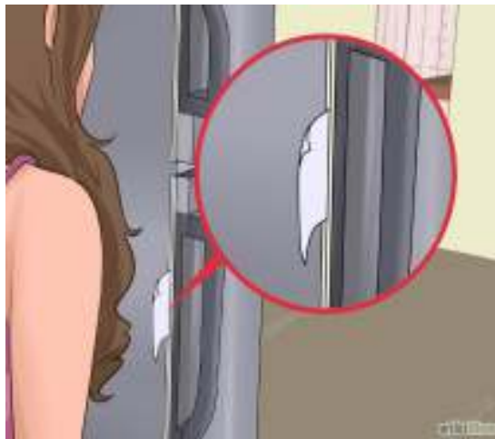
Gambar Memeriksa kerapatan pintu kulkas
