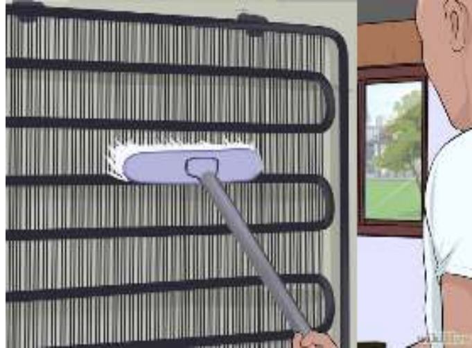
Gambar Membersihkan Kondensor
