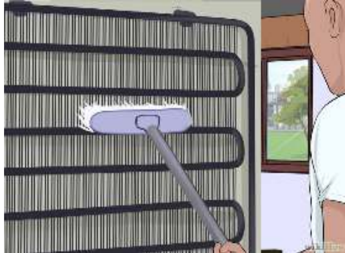
Gambar Membersihkan Kondensor
