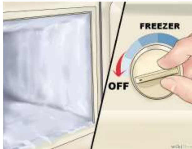
Gambar Mencairkan Es di evaporator
