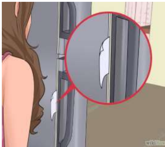
Gambar Memeriksa kerapatan pintu kulkas
