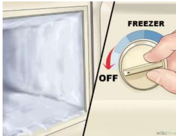
Gambar Mencairkan Es di evaporator
