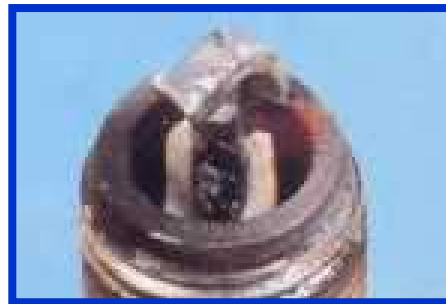
Gambar 4.26. Busi dengan keadaan Elektroda tertekuk dan insulator patah
