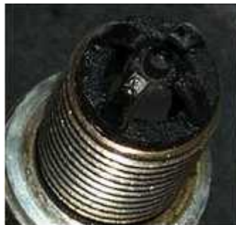
Gambar 4.20. Busi dengan keadaan karbon kotor
