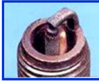
Gambar 4.25. Busi dengan keadaan insulator retak atau pecah.
