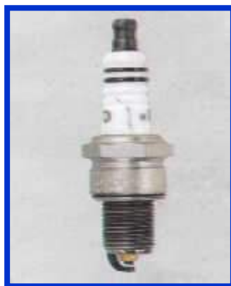
Gambar 4.18. Busi dengan insulator rusak.
