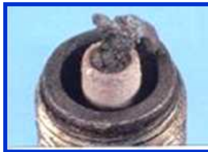
Gambar 4.24. Busi dengan keadaan kepala elektroda terbakar parah.
