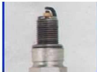
Gambar 4.22. Busi dengan keadaan terdapat endapan pada insulator.
