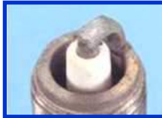
Gambar 4.23. Busi dengan keadaan elektroda terbakar.
