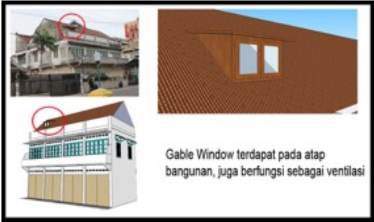
Gambar 5.18. Gabel Window pada bangunan Sumber : Dokumentasi Pribadi
