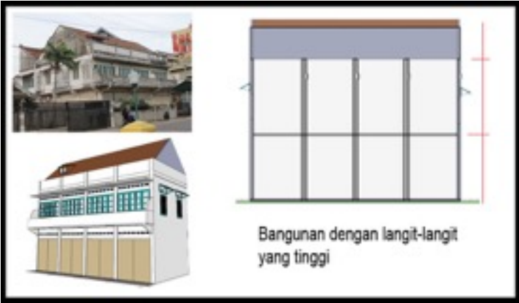
Gambar 5.17. Ketinggian atap Sumber : Dokumentasi Pribadi
