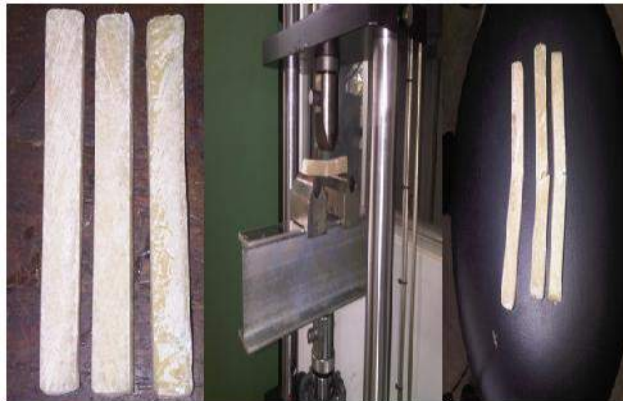
Gambar 6. Pengujian Bending Spesimen Komposit Partikel Marmer
