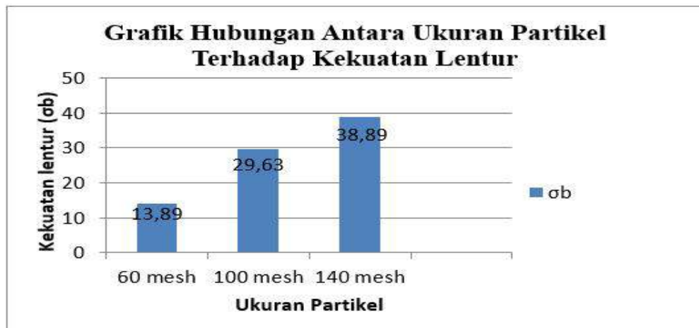
Gambar 7. Diagram Hubungan Antara Ukuran Partikel Terhadap Nilai Kekuatan Bending Komposit Partikel Marmer
