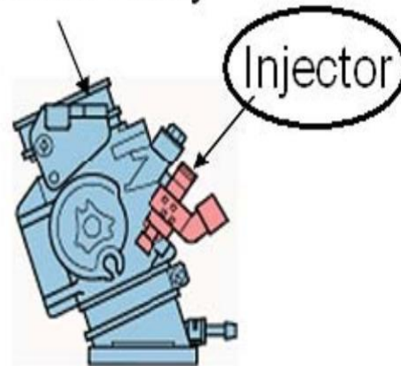
Gambar 2.10 Penempatan Ijektor Pada Throttle Body
