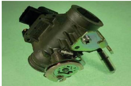
Gambar 2.13 Konstruksi Throttle Body
