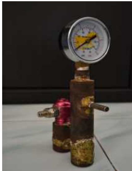
Gambar 3.1 ABS Modifikasi Dengan Pengatur Tekanan Pneumatik
