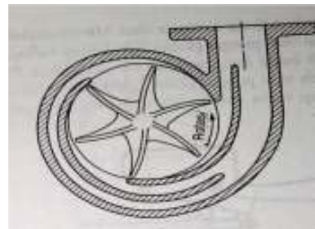
Gambar 2.1b. Rumah keong pompa ganda
