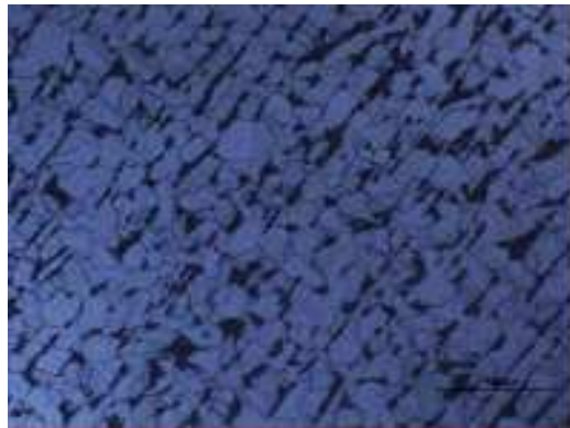
Gambar 3.13b. Bahan Proses Perlakuan Panas 550 °C Pendinginan Air Dengan Pembesaran 200X
