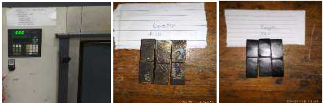
Gambar 3.7. Proses heat treatment pada suhu 600 °C pada media air dan olie
