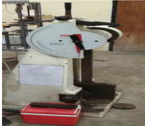
Gambar 3.2. Alat Uji Pukul ( impact )
