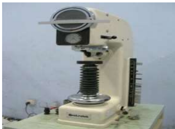
Gambar 3.6. Alat Pengujian Kekerasan Vickers
