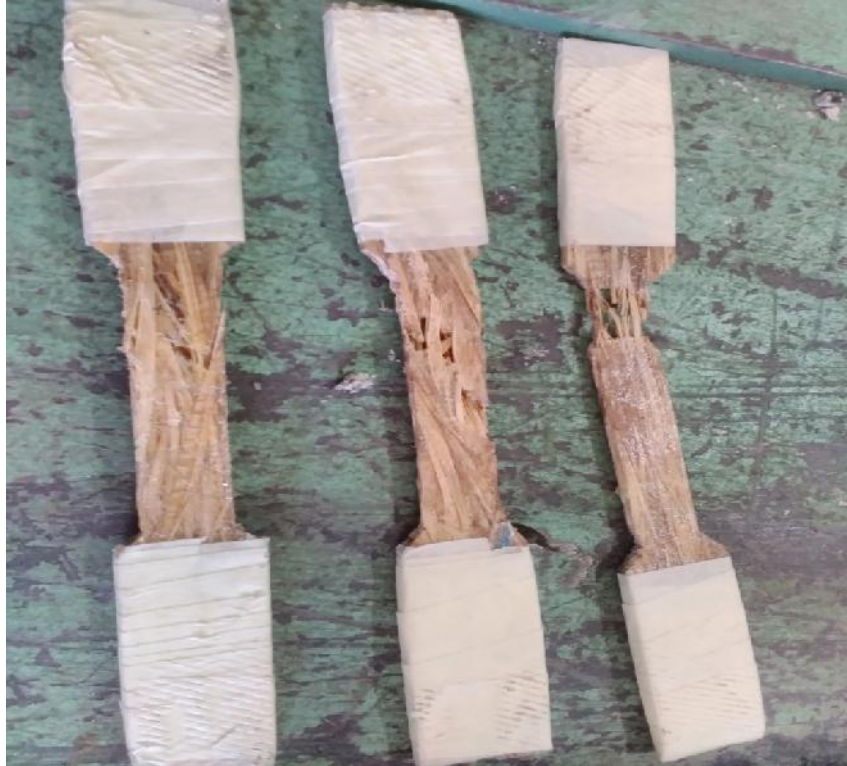
Gambar 3.6 Patahan setelah dilakukan pengujian tarik
