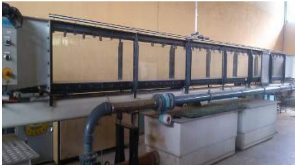
Gambar 4.1 Alat Flume Saluran Terbuka (Lab. Hidrolika Universitas Bandar Lampung)
